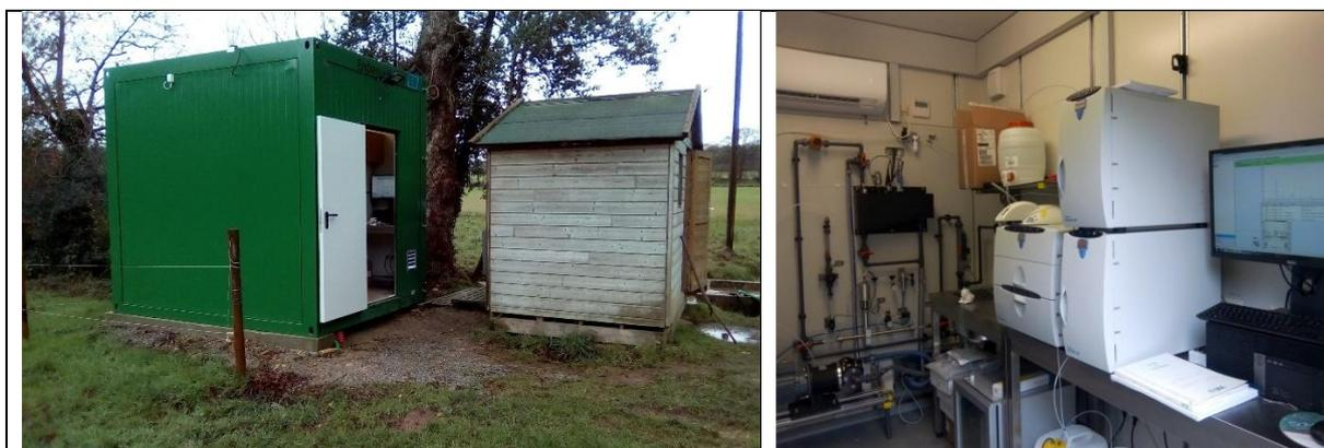
Figure 1 : A gauche : Vue de l'extérieur du Riverlab (la cabane verte) avec le cours d'eau juste derrière lui (presque pas visible). A droite : Vue de l'intérieur du Riverlab avec la chromato ionique en premier plan et la pompe avec les systèmes de filtration en arrière-plan.
